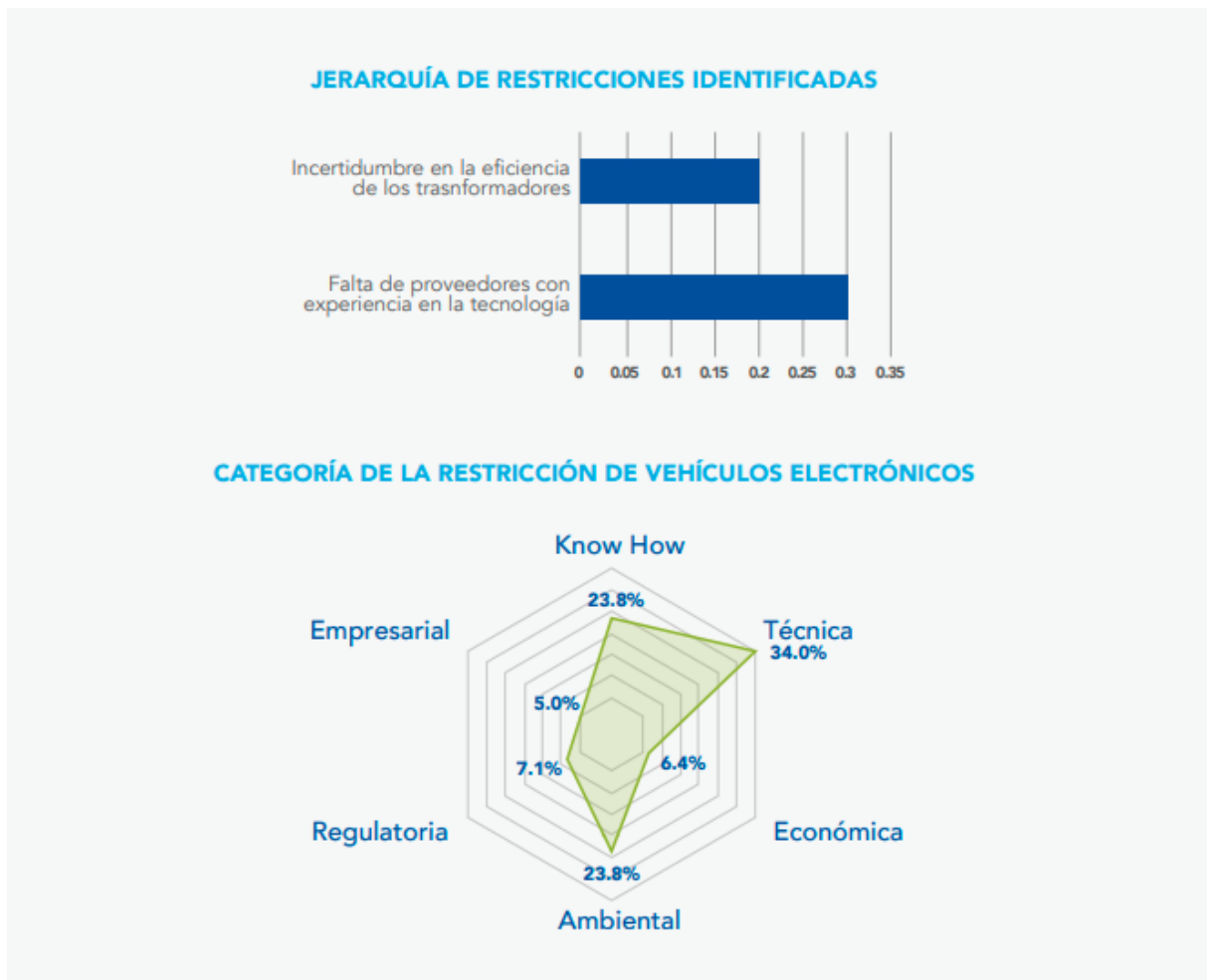
Figura 5.4: Jerarquía y Categoría de Restricciones - Transformadores de Núcleo Amorfo - SEAL
