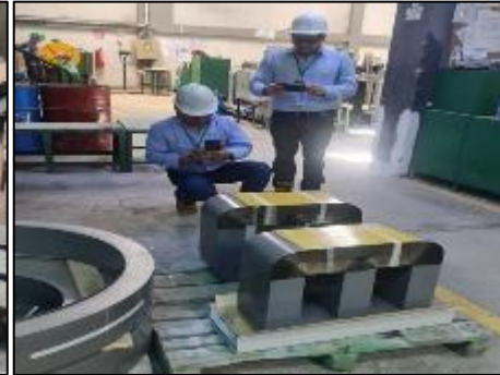
Se observa que el núcleo de material amorfo tiene una cubierta de resina
